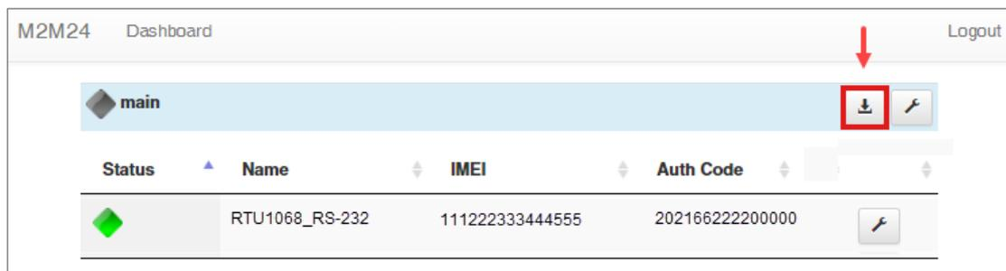
Рис. 9. Загрузка файла конфигурации с сервера M2M24 Cloud.
