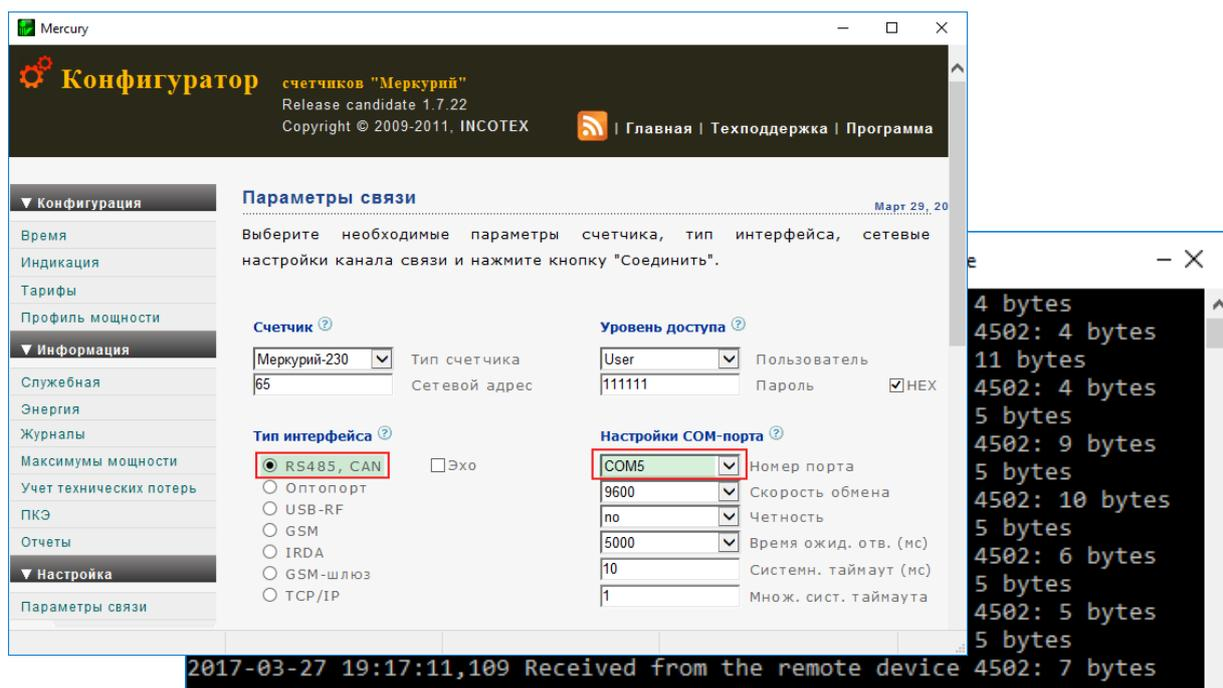
Рис. 15. Настройка подключения «Конфигуратор Меркурий» к серверу M2M24 (COM-порт).
