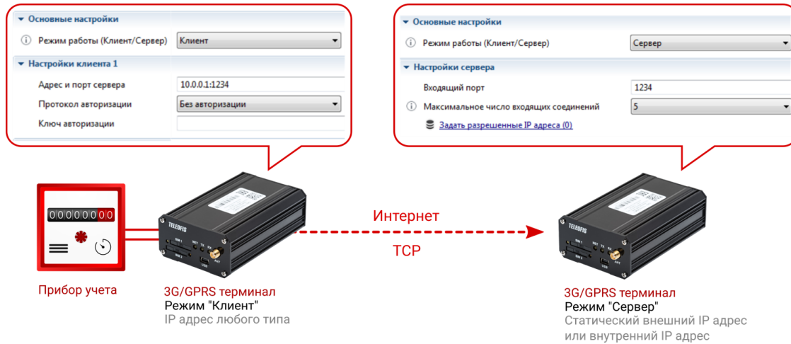
Рис. 19. Схема подключения WRX «Клиент» - WRX «Сервер».
