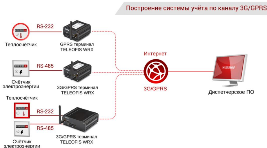
Рис. 2. Построение системы учёта с применением терминалов WRX.
