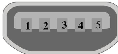
**Рис. 2.2** Разъем micro-USB
