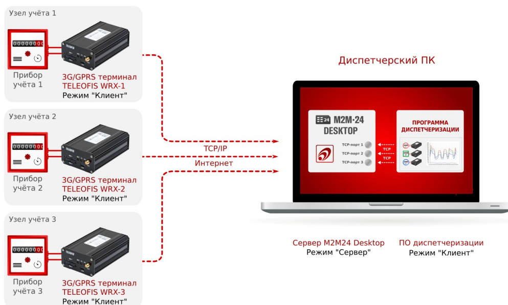
Рис.1. Схема работы сервер M2M24 Desktop.
