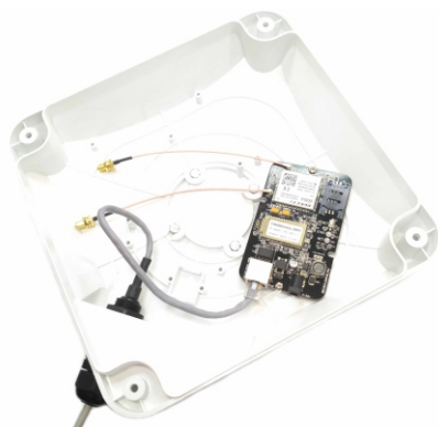
Вариант монтажа в антенну «Antex UNIBOX»
