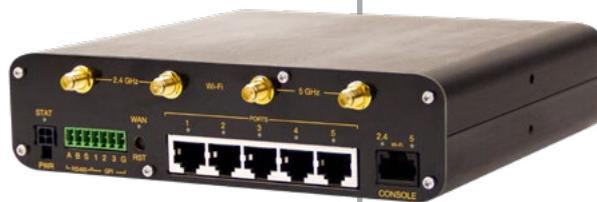
Промышленный 4G роутер с поддержкой до четырёх LTE-модулей, Wi-Fi 5 и GPS. Оснащен гигабитным Ethernet, Wi-Fi, аппаратным GPS, RS485 и GPIO. Обеспечивает многоуровневое резервирование связи, поддерживает современные протоколы шифрования и туннелирования.
