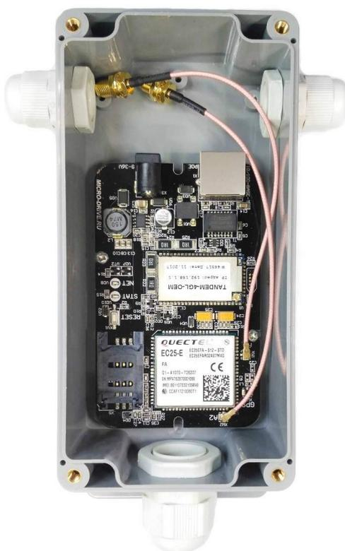
Рис.6.2. Монтаж Tandem-4GL-OEM в гермобоксы «Gainta».
