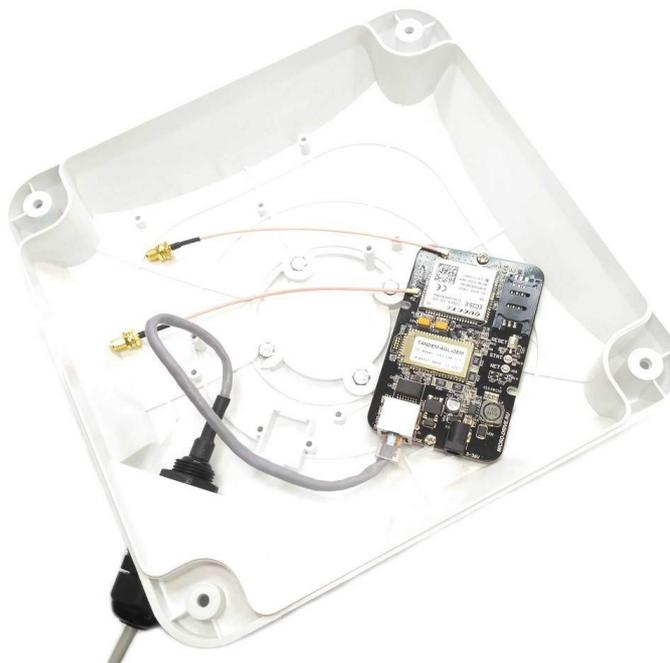
Рис.6.1. Монтаж Tandem-4GL-OEM в герметичную антенну Antex Unibox.
